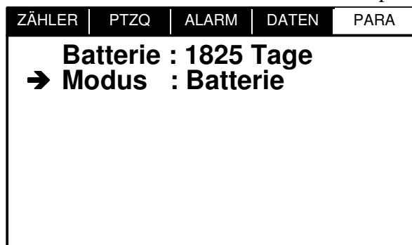
Abbildung 12: Parametrierung der Batterielevensdauer und des Stromversorgungsmodus
